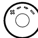
Для ручного управления клапаном при отсутствии термоголовки можно использовать ручной привод ГЕРЦ-TS (арт.№ 1 **7102** 80).
