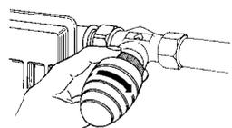
3. Умеренно затянуть ручную накидную гайку (у привода „D” с помощью рожкового ключа).
