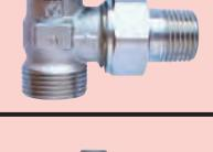
011 | <b>Терmostатический клапан ГЕРЦ-TS-90-H, угловой</b><br>Соединитель для радиатора с уплотнением "сфера-конус". Со стороны входа потока наружная резьба G ¾, евроконус.                                                        | 1/2    | 1 7734 26    | 20           |  |
