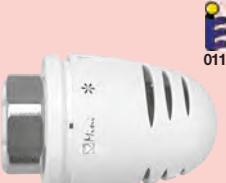
011 | <b>Терmostатическая головка ГЕРЦ-Design-MINI "H"</b><br>с жидкостным датчиком (гидросенсором), с позициями теплового запирания "0" и морозозащиты при прибл. 8 °C. Ограничение и блокировка диапазона настройки 0–30 °C с помощью ограничительных штифтов 1 9551 02 (заказываются отдельно).<br>Размеры: длина 78 мм, диаметр маховика 45 мм. | 1 9200 38    | 20           |  |
