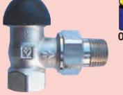
011   | <b>Терmostатический клапан ГЕРЦ-TS-90-H, угловой</b><br>Соединитель для радиатора с уплотнением "сфера-конус". Универсальная модель со специальной муфтой для резьбовой трубы и фитингов. Типоразмеры согласно DIN.           | 1/2    | 1 7724 26    | 20           |  |
