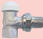
011 | Термостатический клапан ГЕРЦ-TS-90, угловой<br>Соединитель для радиатора с уплотнением "сфера-конус". Универсальная модель со специальной муфтой для резьбовой трубы и фитингов.   | 3/8    | 1 7724 95    | 20           |  |
