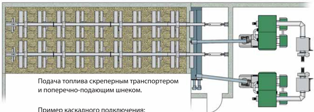
Подача топлива скреперным транспортером и поперечно-подающим шнеком.
