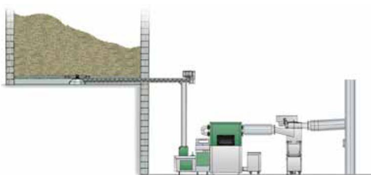
Хранилище топлива и котельная на разных уровнях. Горизонтальная подача перемешивающим механизмом из хранилища с последующей вертикальной насыпкой.
