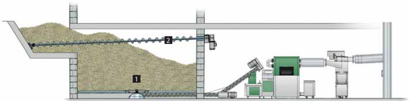
Топливо подается с помощью горизонтального дискового механизма (1), далее по наклонному шнековому механизму. Что позволяет оптимально использовать механизм загрузки склада топлива (2) и объем склада.
