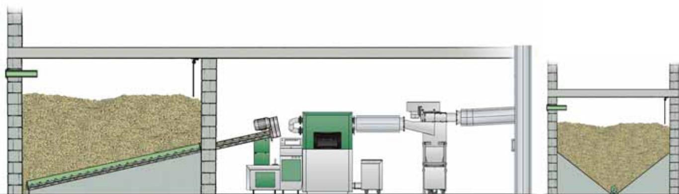
Транспортер пеллет с наклонным шнеком.
