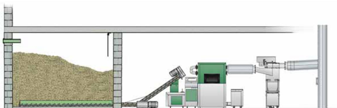
Горизонтальная подача топлива из хранилища, с последующим наклонным шнеком оптимизирует использование объема склада.
