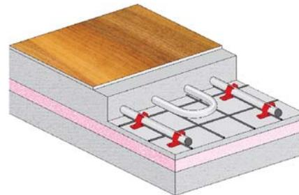
Рекомендуемый интервал между пружинными зажимами 300 - 500 мм, радиус изгиба 5 x D
