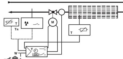
**Регулирование температуры воды в подающем потоке (ступенчатое) для охлаждения, например, фэнкойл. С контролем точки росы и датчиком внешней температуры**
