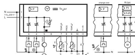
Схема соединений, тип 230 V, 1 7794 23
