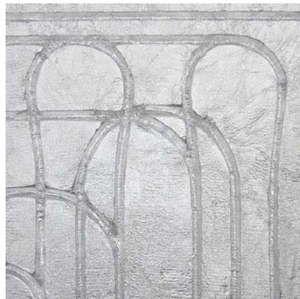
Элемент мультизажимной плиты для зоны разворота труб
