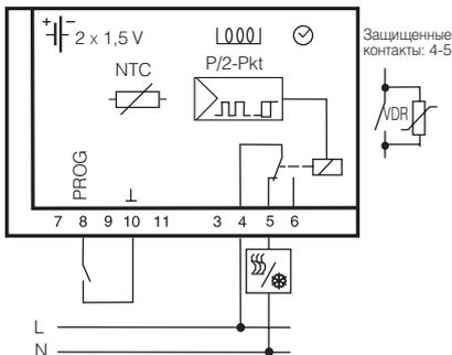
**Схема подключений, вариант исполнения 230 V, 1 7791 23**
