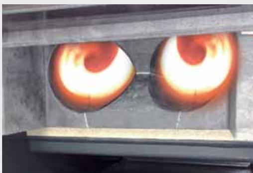
высочайший К.П.Д. благодаря сдвоенной вихревой камере сгорания
