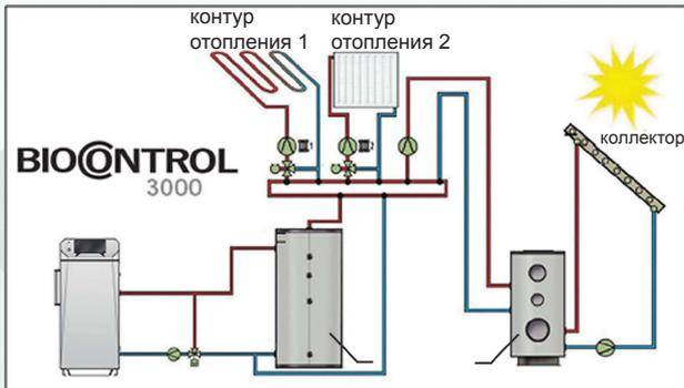
Бак-накопитель 1 использует солнечную энергию и тепло бака-аккумулятора 2.
