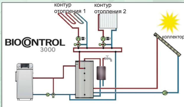
Теплоснабжение от солнечного коллектора и нагрев воды для системы горячего водоснабжения
